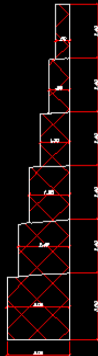
CORTE TRANSVERSAL DE CALZADURA
